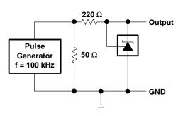
**TEST CIRCUIT FOR PULSE RESPONSE**
