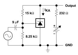
**TEST CIRCUIT FOR VOLTAGE AMPLIFICATION**
