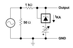
**TEST CIRCUIT FOR REFERENCE IMPEDANCE**
